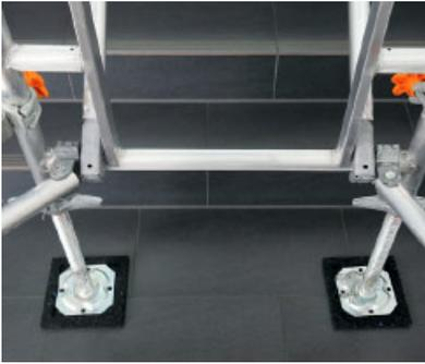
Spindeln sorgen für einen einfachen und präzisen Höhenausgleich und gewährleisten die Standfestigkeit. Gummiunterlagen schützen empfindliche Treppenbeläge vor Schäden.
