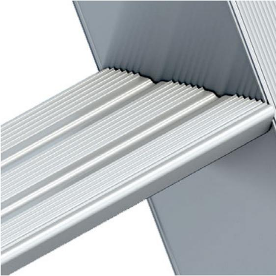
Stufen aus hochfesten Strangpressprofilen ohne Längsschweißnaht mit hoher Beanspruchbarkeit. Diese sind in den Holmen 4-fach verpresst. Die Form der Dreikantsprosse sorgt für Verdrehsicherheit, die Verpressung für eine hohe Seitenstabilität der Leiter. Für ein hohes Maß an Trittsicherheit sorgt die stark geriffelte Trittpläche der Stufen.
