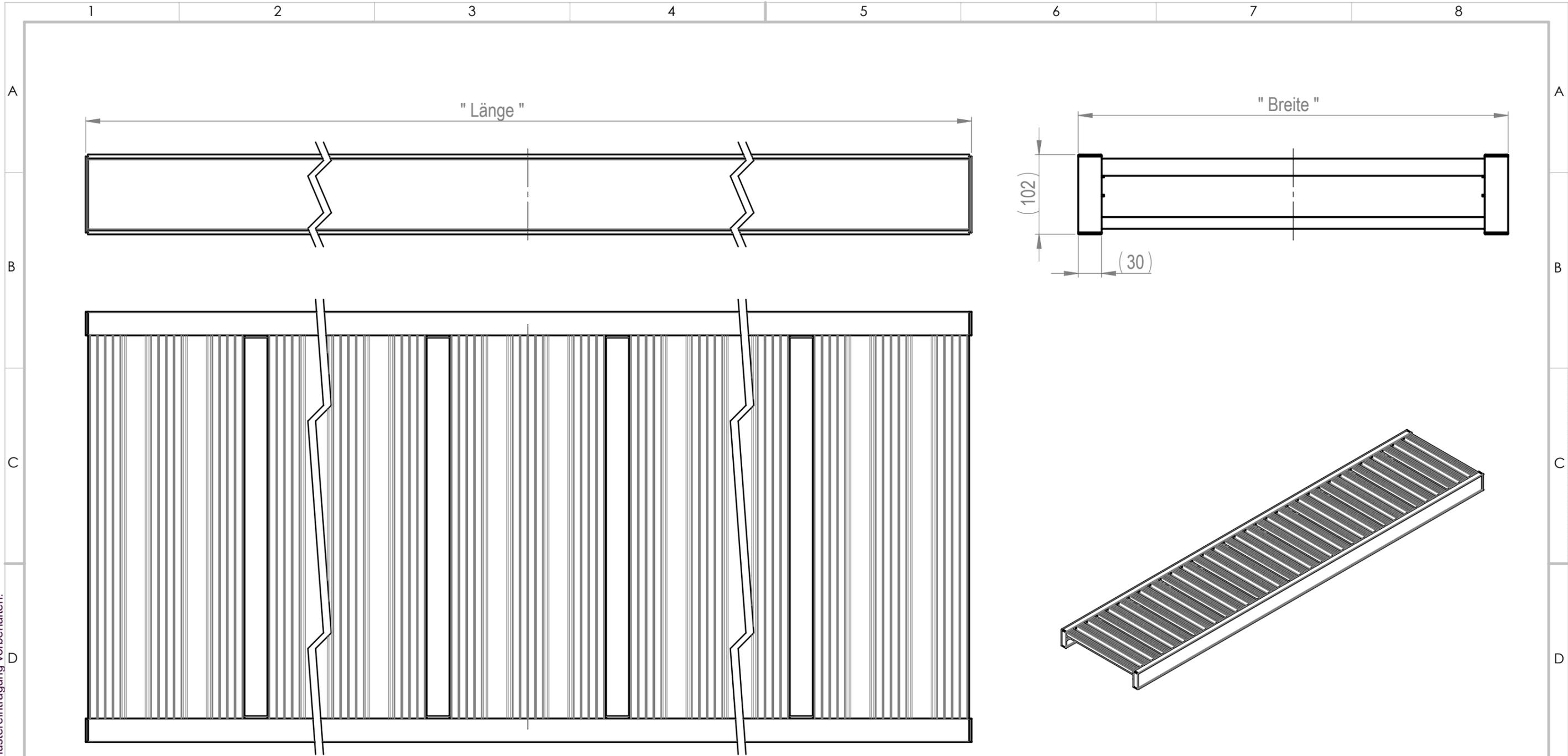
\*Die Tragkraftangaben gelten pro Paar und beziehen sich auf ein zweiachsiges Fahrzeug mit einem Achsabstand von 1500 mm und einer gleichmässigen Lastverteilung (50% zu 50%).
