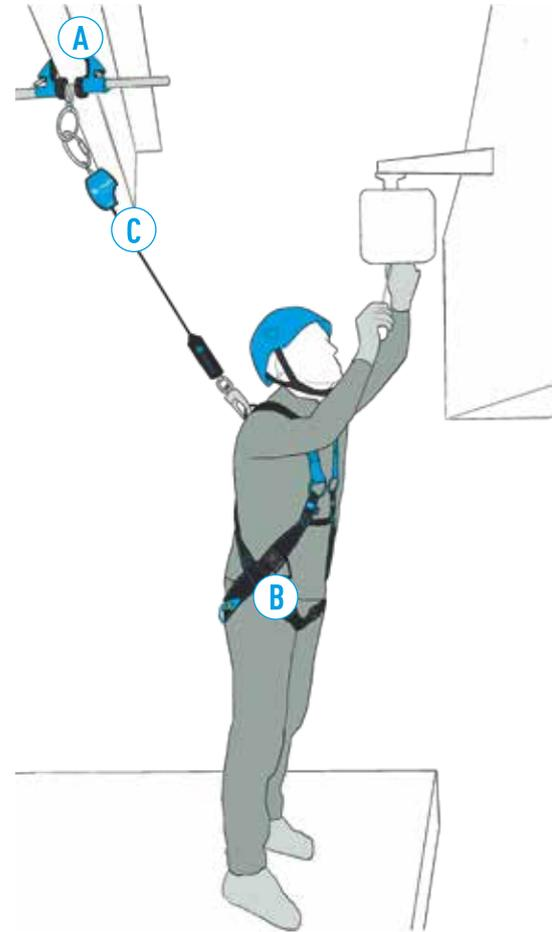
In Industrieanlagen sind nicht immer ausreichend Anschlag-einrichtungen vorhanden. Stahlbaukonstruktionen eignen sich aufgrund ihrer Festigkeit ideal zur Herstellung von temporären Anschlagpunkten für Instandhaltungs- und Wartungsarbeiten in der Höhe.
