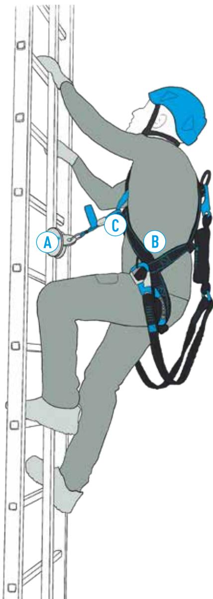
Bei Auffanggurten für die Sicherung an Steigleitern mit Schienen oder Seilsystem ist es wichtig, dass der Läufer leicht mitgeht und nicht beim Aufstieg behindert. Deshalb ist auch die richtige Positionierung des vorderen Anschlagpunktes entscheidend, um den Benutzer beim Auf- und Absteigen zu unterstützen.
