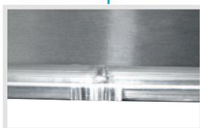
**Hochleistungs-Abbrennstumpfschweißverfahren** nach DIN EN ISO 4063. Durch dieses aufwendige Fertigungsverfahren wird eine hohe Stabilität und Verwindungssteifigkeit erreicht.
