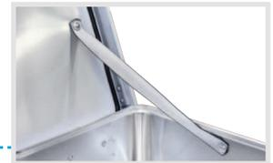
**2 belastbare Deckelgurtbänder.** Enden gegen Ausfransen versiegelt. Kein Ausreißen bei hoher Belastung. Mit Spezialnieten (übergroßer Kopf) befestigt.
