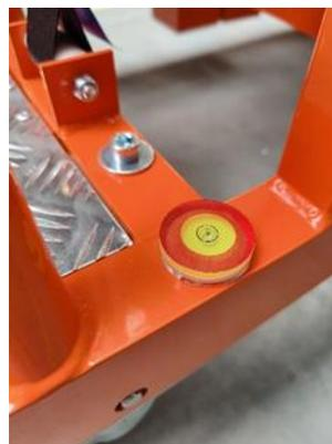
Foto 8. Wasserwaage
