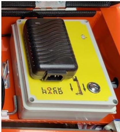
Foto 19. Elektrisches Absenksystem
