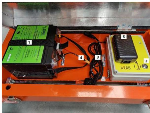
Foto 2. Elektrischer Schaltkasten
