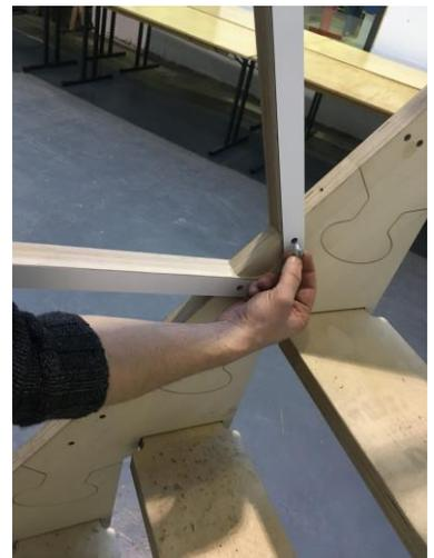
**1.2** Fügen Sie einen Schraubenkopf mit einem Gewindestift zusammen. Diese können nun durch die Bohrungen eingedrückt werden. Auf der Gegenseite soll das Modul nun durch ein weiteren Schraubenkopf gesichert werden.
