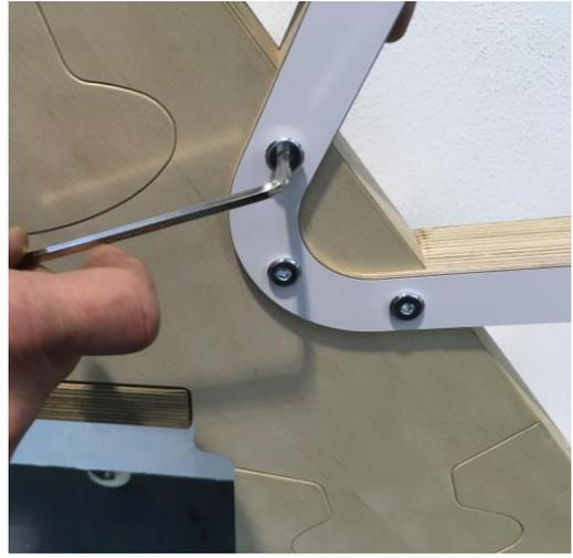
**1.3** Ziehen Sie die Schraube nun mit Hilfe eines 5er Inbusschlüssels beidseitig fest. Wiederholen Sie das Einfügen der Schraube, das Befestigen durch die Schraubenköpfe und das gleichmäßige Anziehen für alle Bohrungen des Moduls.
