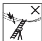
Stel alle door elektrische productiemiddelen in het werkbereik aanwezige risico's vast, b.v. bovengrondse hoogspanningsleidingen of andere onbedekte elektrische productiemiddelen. De ladder niet gebruiken als er risico's door elektrische stroom bestaan.
