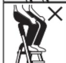
Ne pas utiliser le plateau multifonction ou l'étrier de retenue de l'escabeau en tant que siège.
