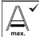
Se till att du öppnar båda delarna på stegen helt säkert innan du använder den.
