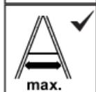
Před použitím dbejte na úplné, zajištěné otevření obou částí žebříku.
