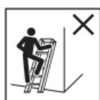
Οι σκάλες μονής πρόσβασης απαγορεύεται να χρησιμοποιούνται ως σκάλες στήριξης σε επίπεδη επιφάνεια, εκτός αν έχουν σχεδιαστεί για τη συγκεκριμένη χρήση.
