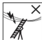
Identifier tous les risques issus d'un matériel électrique dans la zone de travail, par exemple une ligne aérienne à haute tension ou un autre matériel électrique exposé
