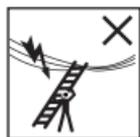
Предостережение! Опасность поражения током! Определите все риски от имеющегося на объекте производимых работ электрооборудования, в т. ч. наружной электропроводки с высоким напряжением или электрооборудования, не имеющего защиту.
