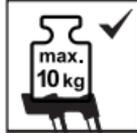
Maksimal belastning er 10 kg på multifunksjonsskallet og festemekanismen på trappestigen.
