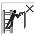
Éviter les efforts latéraux trop importants, p.ex. perçage de trous dans les murs et le béton.
