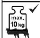
Multifunkční misku nebo přídržný třmen stojacího žebříku zatěžujte maximálně 10 kg.
