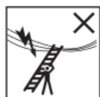
Výstraha, ohrozenie elektrickým prúdom.
