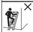
Vrijstaande ladders mogen niet worden gebruikt als aanlegladder, tenzij zij hiervoor zijn ontworpen.
