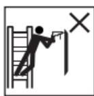
Zabránit práci, která způsobuje boční zatížení stojících žebříků, např. boční vrtání do pevných materiálů (např. zeď nebo beton).
