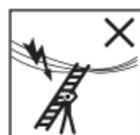
Individuare tutti i rischi derivanti da apparecchiature elettriche nell'area di lavoro, ad es. non utilizzare linee aeree ad alta tensione o altre apparecchiature elettriche esposte e non utilizzare i conduttori se sussiste il rischio di scossa elettrica.
