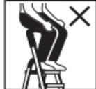
请勿将单侧人字梯的多功能托板或固定夹用作支撑面。
