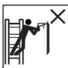
Evite trabalhos que possam submeter as escadas e/ou os escadotes a cargas laterais, p.ex. perfuração de materiais sólidos (p.ex. muros ou betão) em posição virada para o lado.
