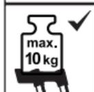
Multifunctionele schaal of borgbeugel van de trapladder met maximaal 10 kg belasten.
