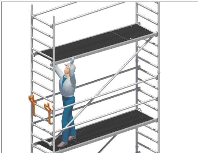
3. Diagonalen und Durchstiegsbrücke einsetzen.
