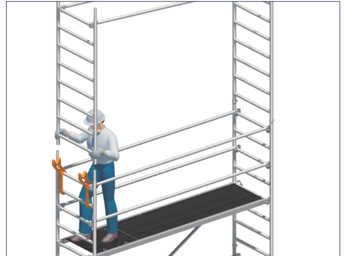
2. Standleiter mit Geländer nach oben schwenken und aufstecken.
