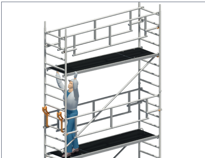
3. Diagonalen und Durchstiegsbrücke einsetzen.
