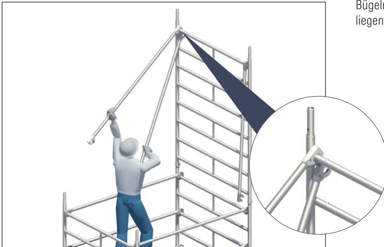
8. Demontage der Geländer 12 durch öffnen der Einrastklau mithilfe von einem der unter 3. demontierten Zwischengeländer. Das lose Geländer 12 wird auf die 2. Sprosse von oben aufgelegt und wirkt als Hebel zum Öffnen des Schließbügels der Einrastklau (siehe Detail).
