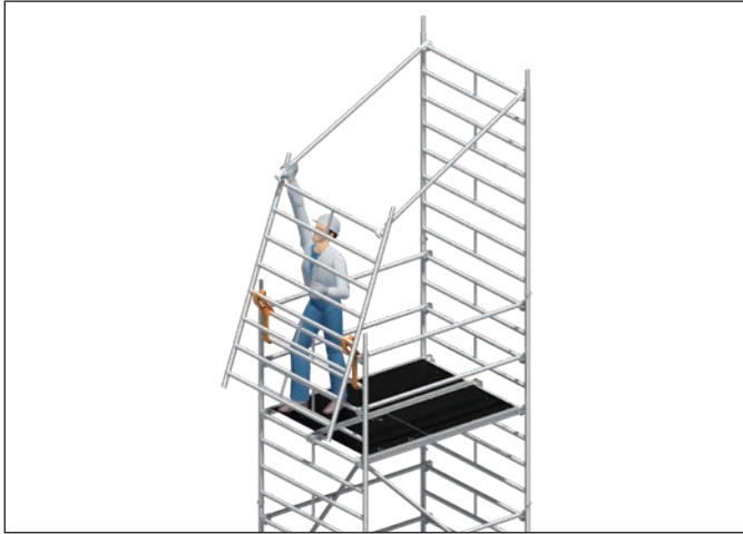
7. Einseitiges Aushängen der Geländer 12 aus der positionierten Standleiter.
