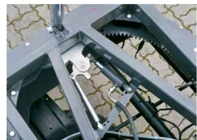
Optional mit hydraulischer Drehkranzverstellung
