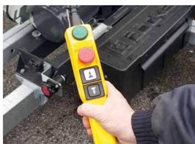
Elektrische Steuerung mit Schleifgang (optional)
