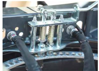
Stufenlos verstellbarer Drehkranz mit mechanisch lösbarer Sperre
