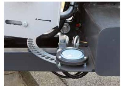
Mehrfach verstellbarer Drehkranz
