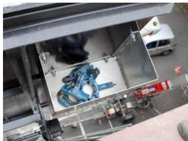
Pritsche ist mit Ablagefächern für Kleinteile ausgestattet
