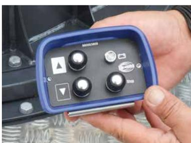
Optionale Bedienung unten über Funksteuerung
