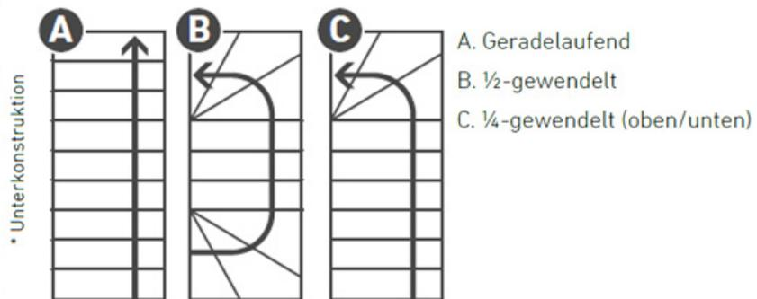
Mittelholmtreppe Cork mit 65, 75 oder 79 cm Treppen-/Stufenbreite - Geradelaufend, 1/2- oder 1/4-gewendelt
