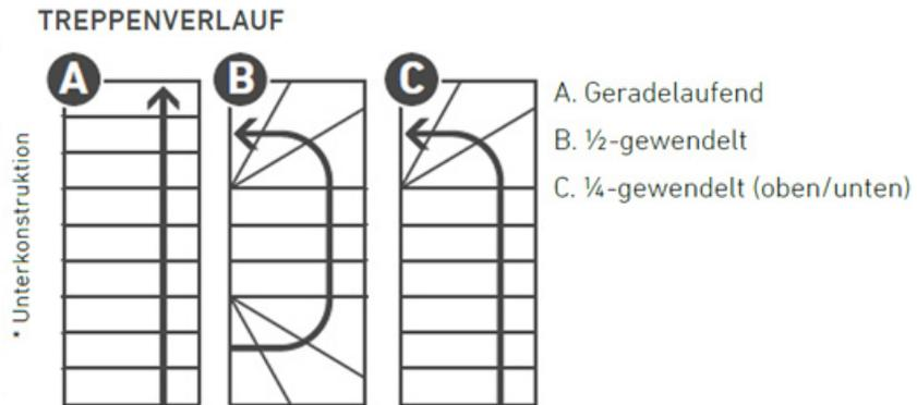
Mittelholmtreppe Cork mit 65, 75 oder 79 cm Treppen-/Stufenbreite - Geradelaufend, 1/2- oder 1/4-gewendelt
