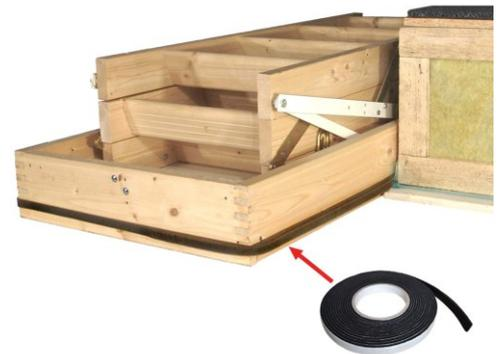
Das Passivhaus-Einbauset single bietet einen perfekten luftdichten Abschluss für Dachbodentreppen ohne Stahlzarge und ist ideal für den Einsatz in Niedrigenergie- und Passivhäusern. Durch das integrierte Fugendichtband wird eine hervorragende Luftdichtheit gewährleistet, wodurch Wärmeverluste effektiv vermieden werden.
