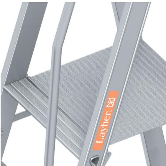
Die große Plattform mit 480 x 420 mm aus rutschsicherem Riffelblech sorgt für sicheren Stand vor allem bei längerem Verweilen auf der Leiter. Beidseitig am Holm montierte Handläufe ermöglichen einen sicheren Halt beim Auf- und Abstieg. Eine zusätzliche Knieleiste und eine auf 1 Meter Höhe über der Plattform angebrachte Haltevorrichtung in Form einer zweigeteilten Werkzeugablageschale aus Aluminium sorgen für guten Stand und damit sicheres Arbeiten. Die
