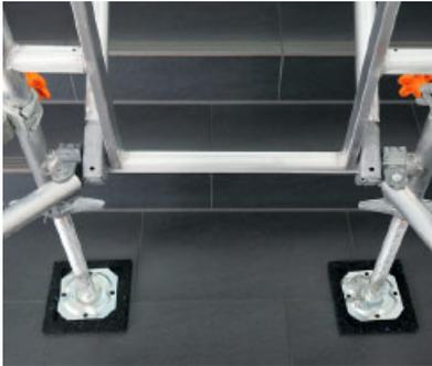
Spindeln sorgen für einen einfachen und präzisen Höhenausgleich und gewährleisten die Standfestigkeit. Gummiauflagen schützen empfindliche Treppenbeläge vor Schäden.
