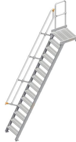
**Gewicht:** 73.4 kg**Stufenbreite:** 600 mm**Neigung:** 60°**Plattformlänge:** 0,60 m**Plattformbreite:** 0,60 m**Podest:** ja**Senkrechte Höhe:** 3,15 m**Sprossen/Stufen:** 14**Trittform:** Stufen**Hersteller:** Layher**Teilbarkeit:** 1x**Material:** Aluminium**Kategorie:** Treppen**Begehbarkeit:** einseitig
