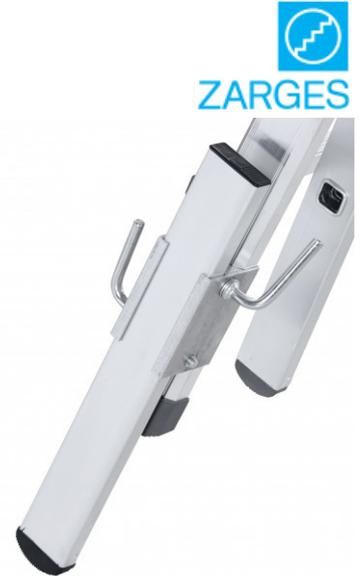
Holmverlängerung stufenlos höhenverstellbar, Verstellbereich 350 mm.
