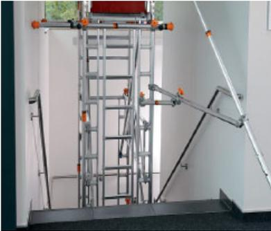
Die im Treppen-Kit beigefügte Einhängeleiter ermöglicht eine sichere und senkrechte Aufstiegsmöglichkeit zur Arbeitsebene.
