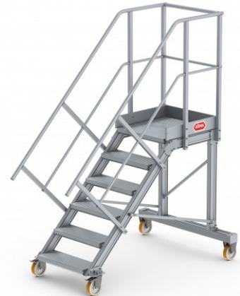
**Stufenbreite:** 600 mm**Standhöhe:** 1,24 m**Neigung:** 45°**Arbeitshöhe:** 3,24 m**Sprossen/Stufen:** 6**Trittform:** Stufen**Hersteller:** Altrex**Material:** Aluminium**Kategorie:** Podesttreppe**Eigengewicht:** 56,6 kg**Begehbarkeit:** einseitig
