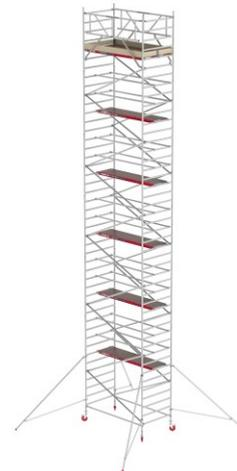
**Plattformbreite:** 1,35 m**Gerüsttyp:** RS Tower 42**Standhöhe:** 12,2 m**Plattformlänge:** 1,85 m**Arbeitshöhe:** 14,2 m**Hersteller:** Altrex**Material:** Aluminium**Kategorie:** Rollgerüst
