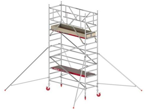
**Plattformbreite:** 0,90 m**Plattformlänge:** 2,45 m**Gerüsttyp:** RS Tower 41 PLUS**Standhöhe:** 3,2 m**Arbeitshöhe:** 5,2 m**Hersteller:** Altrex**Material:** Aluminium**Kategorie:** Rollgerüst
