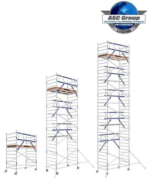
Das ASC Rollgerüst mit ASG PRO-Geländer bietet die Möglichkeit, bereits beim Aufbau ein Geländer als Absturzsicherung für die nächst höhere Plattformebene von unten zu installieren. Somit ist die Absturzsicherung für die nächste Plattform schon vor dem Einlegen derselben hergestellt. Beim Aufstieg ist man somit bereits voll umfänglich geschützt. Dies schafft Sicherheit und ist eine schnelle und dauerhafte Lösung für den sicheren Auf- und Abbau.
